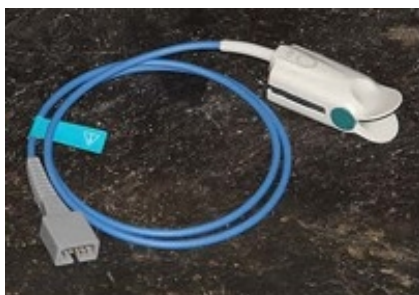
Sensor articulado para dedos, mostrando conector que deve ser acoplado ao monitor alinhando a lacuna do conector ao encaixe correspondente na máquina
